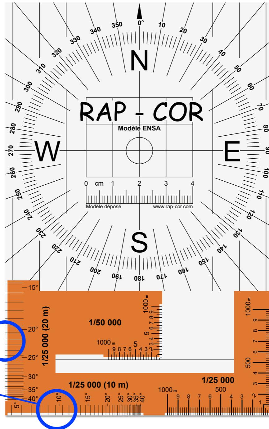
Rapporteur de pentes en degrés entre deux courbes de niveau espacées de 20 m (échelle 1:25 000)
