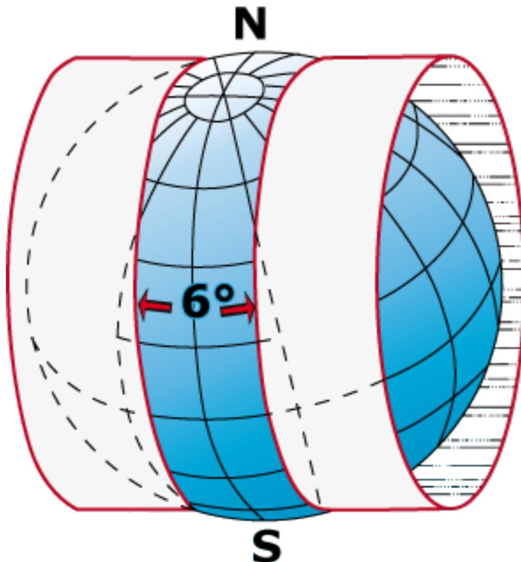
La projection Transverse Universelle de Mercator (en anglais Universal Transverse Mercator ou UTM) est une **projection cylindrique conforme**.
